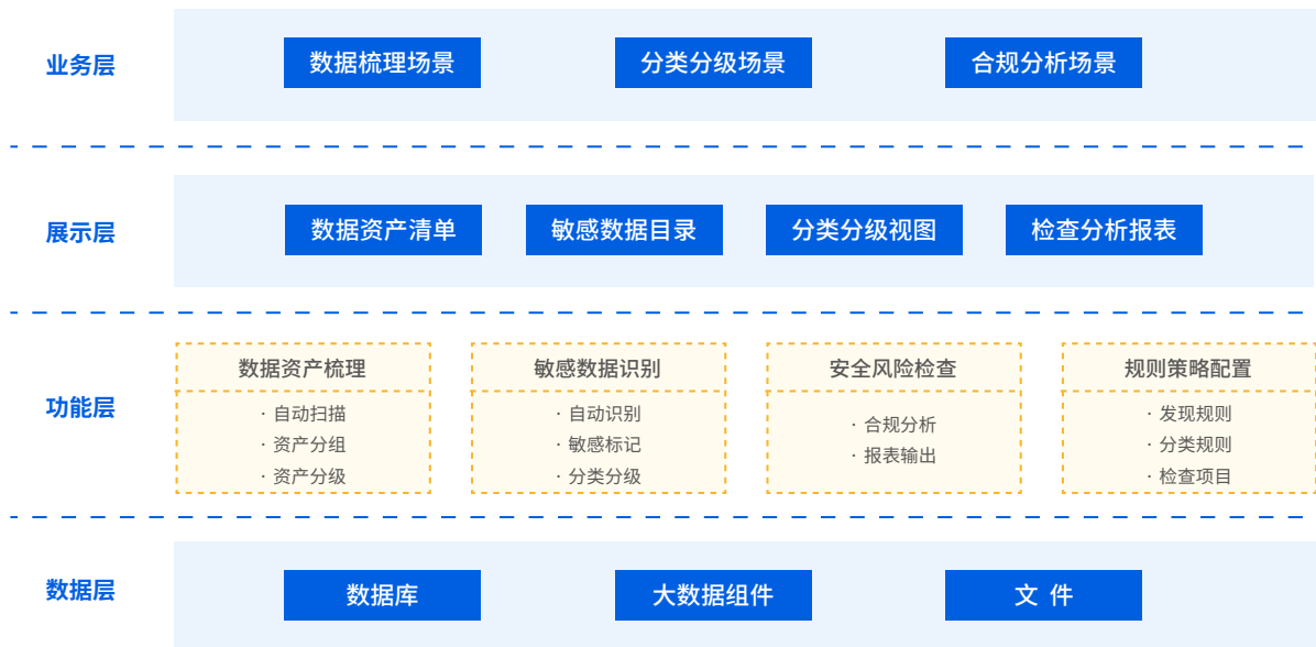
图7 敏感数据发现系统架构设计
